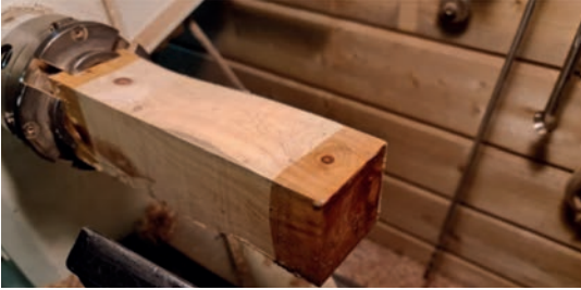
Stap 1a. Draai een cilindrische vorm.
