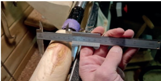
Stap 2. Meet de diameter op met de schuifmaat.
