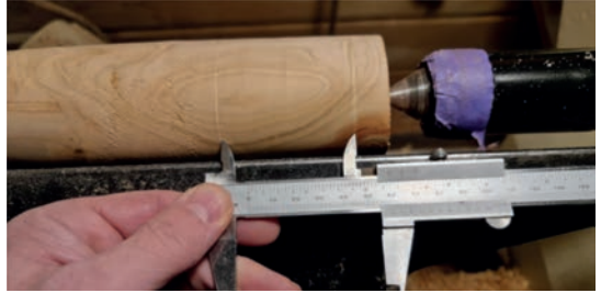
Stap 3. Neem deze maat over overdwars op de cilinder.
