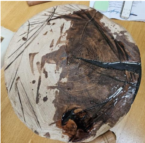
Schijf van een eiken stam met krimpscheur gevuld met gekleurde epoxy Kan gebruikt worden voor schaal.
