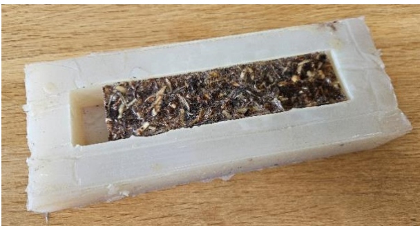
Gietmal van siliconen-rubber Epoxy met houtkrullen te gebruiken voor pennen e.d.
